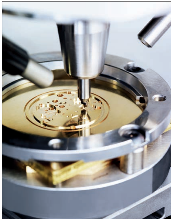
Usinage d'une platine effectué avec le centre d'usinage 701S. Source : Willemin-Macodel
