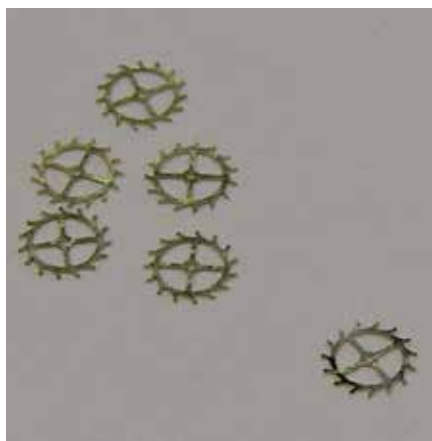
Roues d'ancre taillées par le procédé du taillage par génération.
