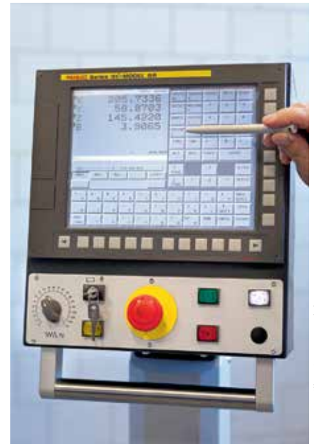
CNC Fanuc doté d'une interface spécifique au secteur dentaire.
