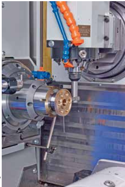
Taillage par génération d'une roue cylindrique à denture droite.
