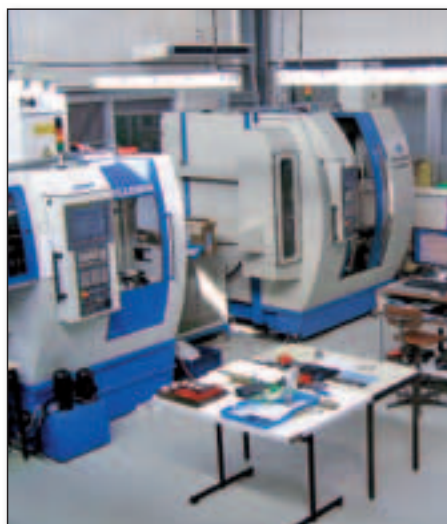
SFM utilise des centres d'usinage Willemin-Macodel pour l'usinage de bijoux. Source : SFM
