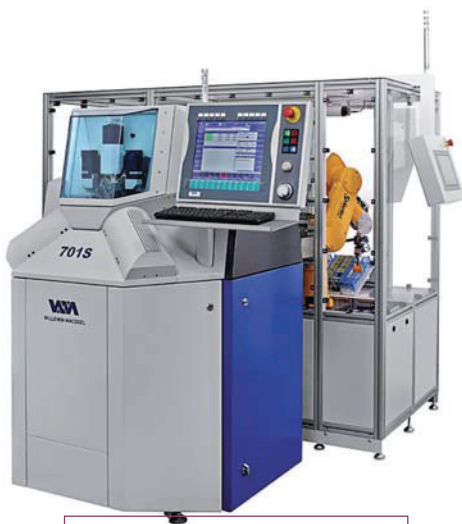
Equippée d'un système robotisé, la machine 701S peut être mise en réseau avec plusieurs autres machines pour devenir un centre d'usinage transfert ultra-flexible.
