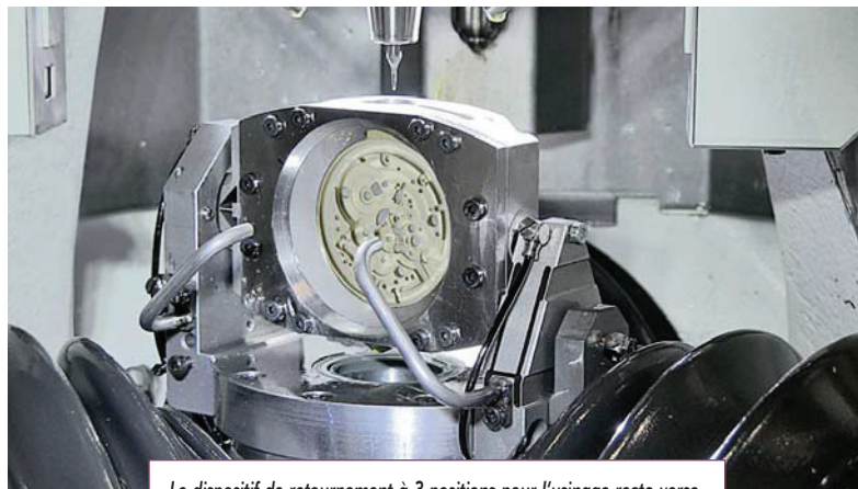
Le dispositif de retournement à 3 positions pour l'usinage recto-verso.
