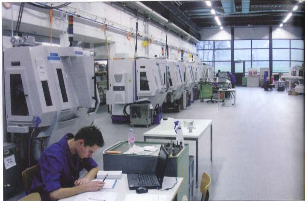
Une partie de l'atelier de montage des machines. Celles-ci sont toutes assemblées sur une base commune avant de recevoir les spécificités des clients.
