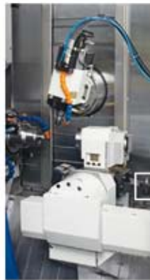
In der Zahnindustrie ist das Modell 508S besonders gut für die Bearbeitung von Brücken aus Titan oder Chrom-Kobalt-Legierungen geeignet.
