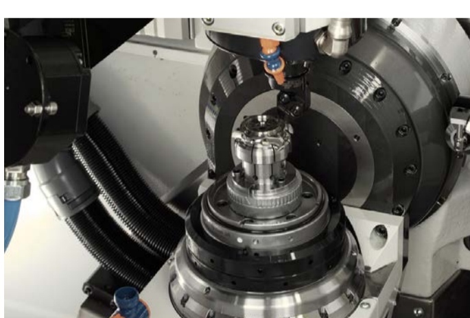
Doppio divisore che consente operazioni di tornitura fino a 4.000 min -1
