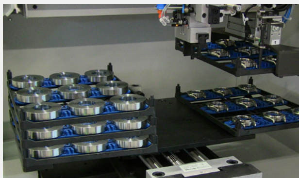
Pallet di carico standard che favoriscono una agevole integrazione nel flusso di produzione.
