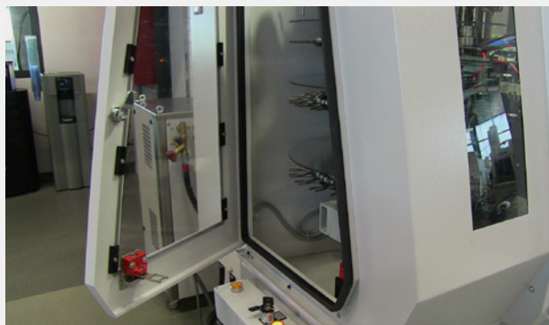
Magazzino utensili accessibile durante la produzione
