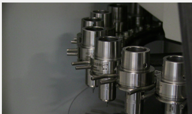
Magazzino utensili accessibile durante la produzione
