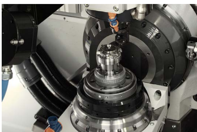
Double diviseur permettant des opérations de tournage jusqu'à 4'000 min -1
